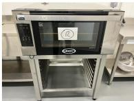
Four en inox électrique UNOX modèle XEFR-03EU-ETDV de 2024 avec support inox de rangement de grilles
