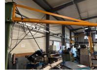
Palan DEMAG pour 0,4 Tonne
