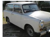
**TRABANT P601 break Universal.** Née en 1964, la Trabant P601 n'est qu'une évolution de la Trabant P50. Sur une structure métallique, vient prendre place une carrosserie en Duroplast, une matière synthétique formée de fibres de tissus pressées dans de la r
