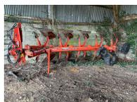
Charrue réversible KUHN vari master 153 à 5 corps, sécurité non stophydraulique, roue de terrage hydraulique pieds d'usure en carbone, année 2013 (Vente faite en HT)
